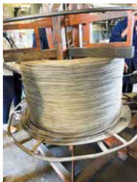
Ab Rolle wird der Draht durch Lochschablonen mit verschiedenen Durchmessern gezogen.
