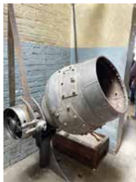
Kein Betonmischer, sondern eine Nagel-Waschmaschine
